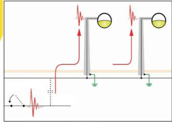
Bei Schalthandlungen im Netz werden Spannungsspitzen von mehreren Tausend Volt erzeugt, welche sich im Niederspannungsnetz ausbreiten und Ihre Beleuchtungsanlage belasten.
