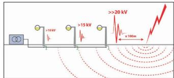
Blitzeinschläge können je nach Entfernung des Einschlagortes, der Boden- und Erdungsverhältnisse sowie der Blitzstärke sehr hohe Werte erreichen.
