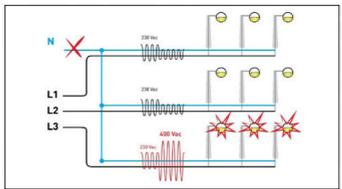
Netzfehler können zu sogenannten temporären Überspannungen führen.
